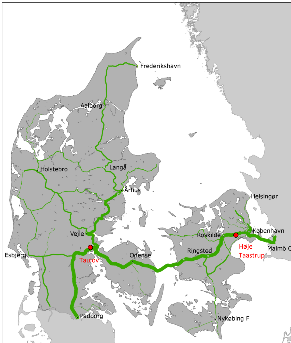
Figur 9: Godsmængder på det danske jernbanenet (kilde; Schneider-Tilli, 2009, side 2). Terminaler tilføjet med rødt.
